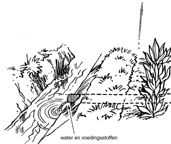
Fig. 6.4 Steenwol houdt water en voeding slecht vast.
